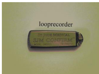
Figuur 1. Looprecorder (grootte ongeveer een pink)
